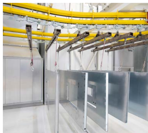
正在等待喷涂的镀锌钢门扇
